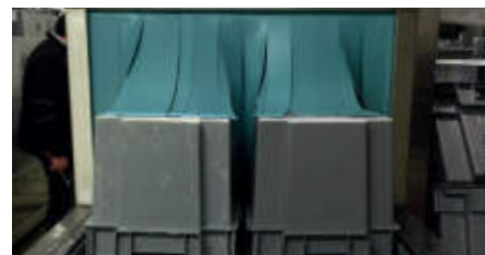
Tunnel für Waschboxen
